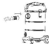
**ATENȚIE:** Înainte de a porni aparatul, asigurați-vă că ansamblul furtunului este în poziție, altfel aparatul s-ar putea deforma.
