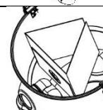
K sběrné nádobě namontujte vrchní část vysavače a zajistěte ji pomocí uzávěru nádrže.
