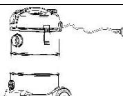
Ataşați partea superioară a aspiratorului la recipientul de colectare și fixați-o cu cârligul.
