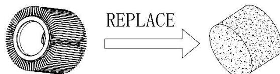
Scoateți filtrul HEPA din coșul pentru filtru și instalați filtrul spumă.
